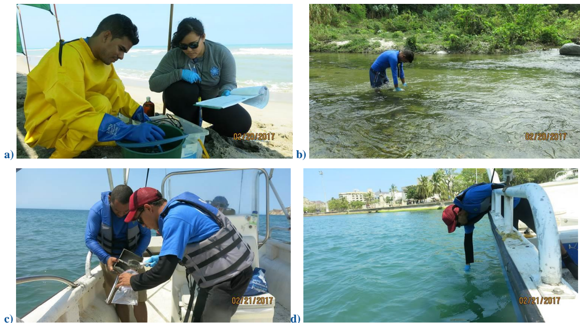
Figura 1.2. Salida de campo REDCAM. Medición de parámetros in situ (a) y recolección de muestras de agua (b y c) y de sedimentos (d), fotos: INVEMAR.
